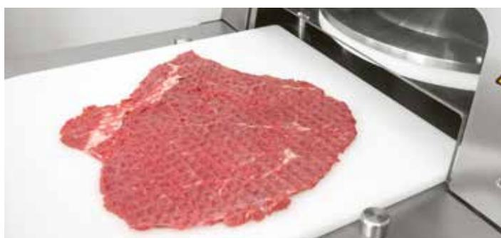
Der MAGA® Fleischplattierer beginnt automatisch mit dem Pressvorgang, wenn die Ablage eingeschoben wird.
